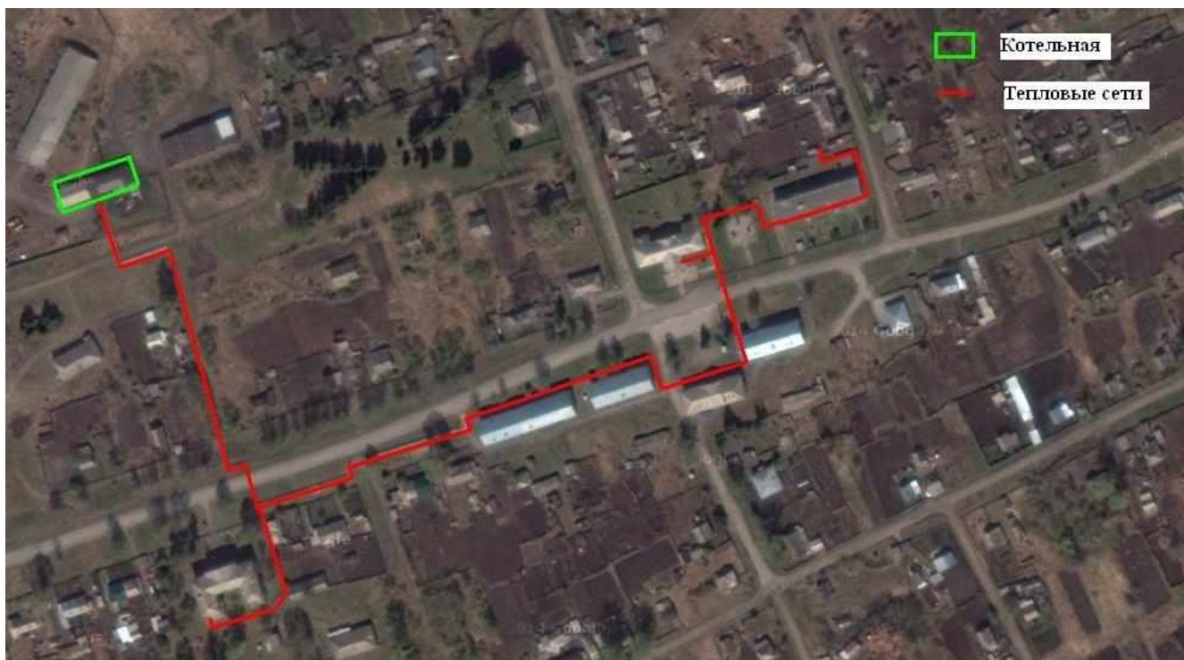
Рис.2. Существующая зона действия коммунальной котельной п. Центральный
